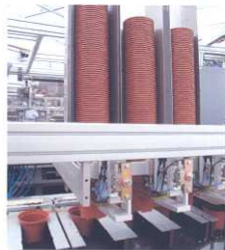
De pottenbunkers kunnen verschillende potmaten bevatten. Omstellen is zeer eenvoudig.
