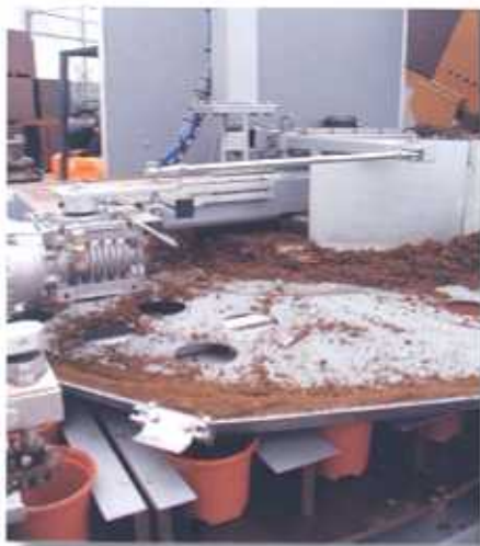
De potten worden gevuld door een matrix heen, waardoor er bijna geen grond verspild wordt.
